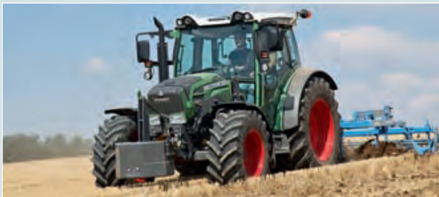
С выпуском новой модели серии 200 Vario фирма Fendt перевела все тракторы на бесступенчатую коробку передач.
