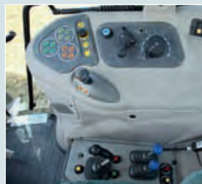
Коробка передач Vario заимствована у 300-й серии. Она имеет один диапазон хода и позволяет развивать до 40 км/ч, управляется через Vario-stick, вместо джойстика, которым снабжены тракторы специального назначения.
