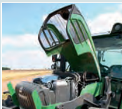
Спереди расположен основной топливный бак, который вместе с дополнительным баком вмещает 125 л. Охлаждение радиатора происходит с обеих сторон и сверху. Мощность трехцилиндрового двигателя Sisu в модели Vario 211 составляет 81 кВт/110 л.с.
